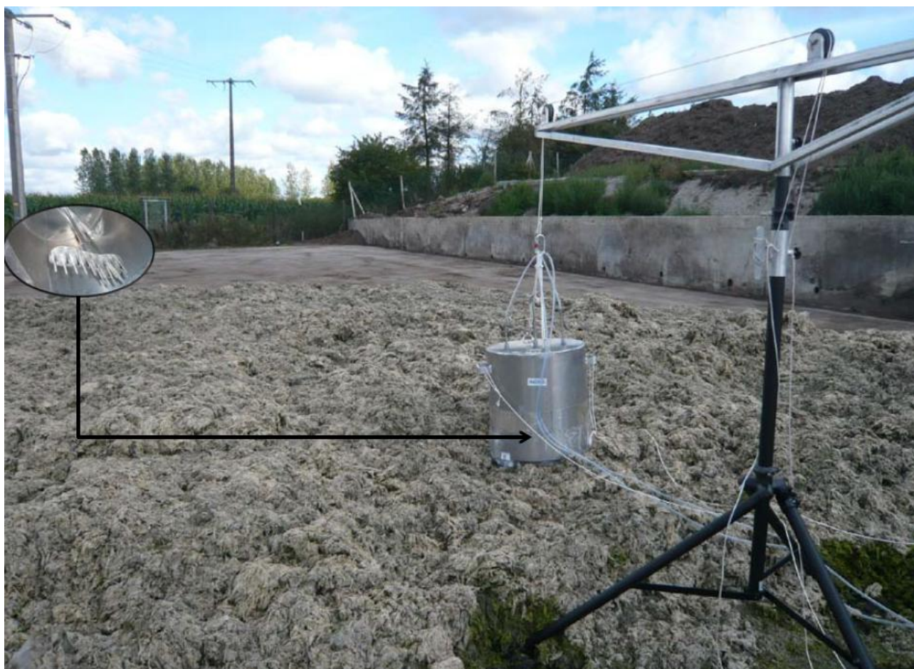
Figure 9 : Dispositif expérimental des mesures au-dessus d'un tas d'algues ex situ reproduit sur une plateforme (Ineris, 2011)
