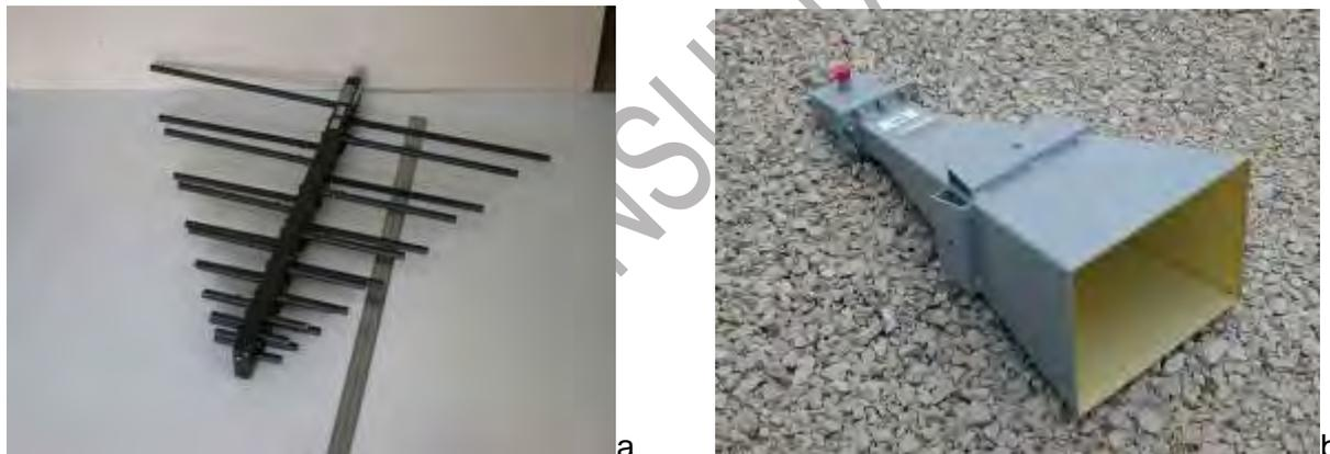
Figure 17 : Exemples d'antennes d'illumination hautes fréquences : log-périodique (a), cornet (b).
