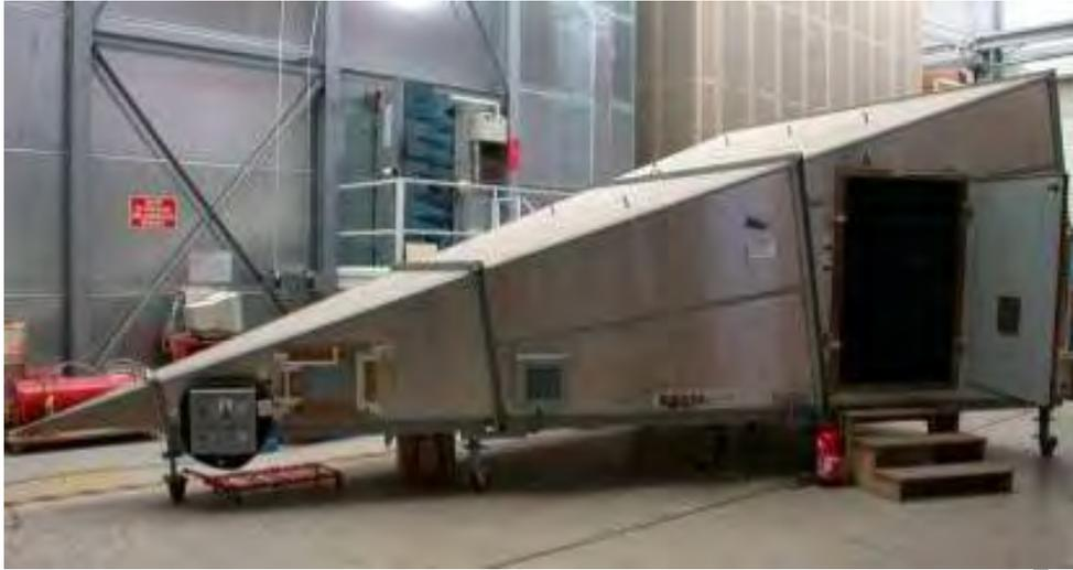
Figure 21 : Exemple de cellule GTEM de grande dimension (3 m x 1,6 m x 1 m).
