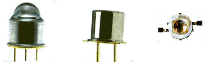
Figure E2 : Exemples de DEL avec lentille dôme et lentille plate ( www.biouvled.com )
