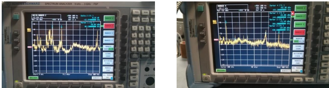
Figure 7 : exemple de résultat d'analyse spectrale entre 9 kHz et 100 kHz (à gauche) et entre 100 kHz et 500 kHz (à droite)
