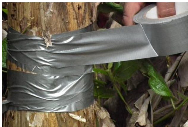
Figure n° 4. Fermeture de la « fenêtre » d'échantillonnage avec du ruban adhésif
