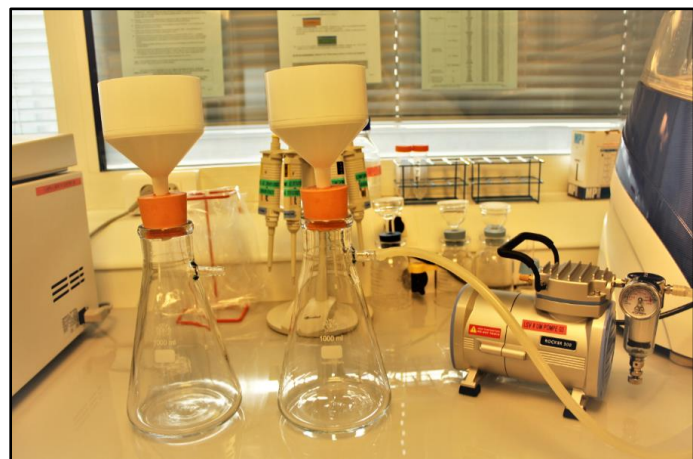
Figure 3 : dispositif de filtration composé de deux portes filtre entonnoir de type Büchner, de deux fioles à aspiration, et d'une pompe à vide. Le premier porte filtre est équipé d'un filtre à 60 µm, le second d'un filtre à 20 µm.
